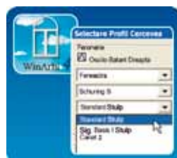
Fereastră două canate, oscilo/batantă - Standard Stulp = deschidere oscilo batantă, mâner amplasat simetric, puncte închidere cu rolă. - Sig. Basis I Stulp = deschidere oscilo batantă, mâner amplasat simetric, un punct închidere tip ciupercă. - Canat 2 = deschidere simplă, închidere cu zavoare.
