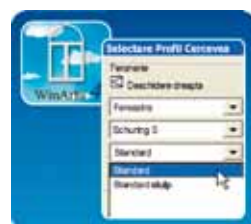
Fereastră un canat, deschidere simplă - Standard = deschidere simplă, închidere perimetrală, puncte închidere cu rolă.
