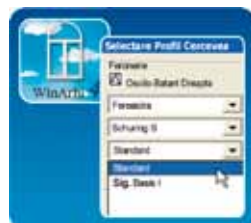
Fereastră un canat, oscilo/batantă - Standard = deschidere oscilo batantă, mâner amplasat simetric, puncte închidere cu rola - Sig. Basis I = deschidere oscilo batantă, mâner amplasat simetric, un punct închidere tip ciupercă.
