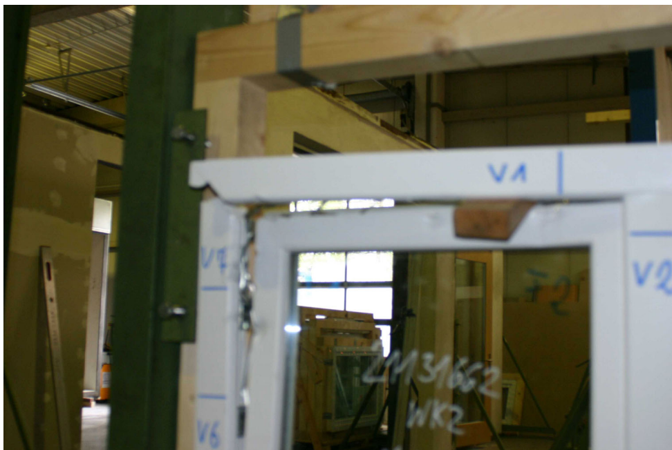
Bild 4 Schäden aus der manuellen Prüfung auf der Griffseite
